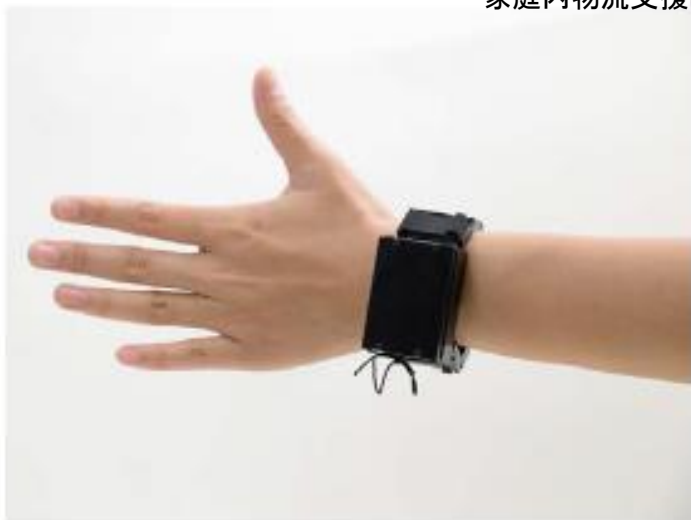
手首凹凸のみから手先形状を推定するウェアラブルデバイス
